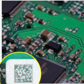
**读取电子元件 PCB 上的代码**
