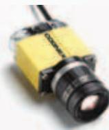
C 接口镜头的多样性扩大了 DataMan 100 读码器可使用镜头的范围。
